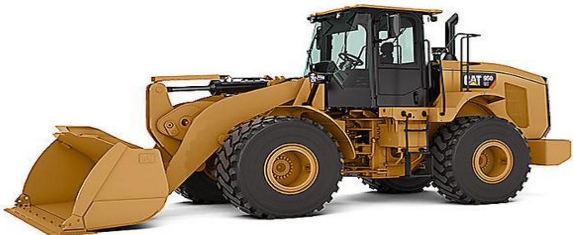
**Fig. 6.6 Modelo de pá-carregadeira sobre pneus, Fonte: caterpillar**
