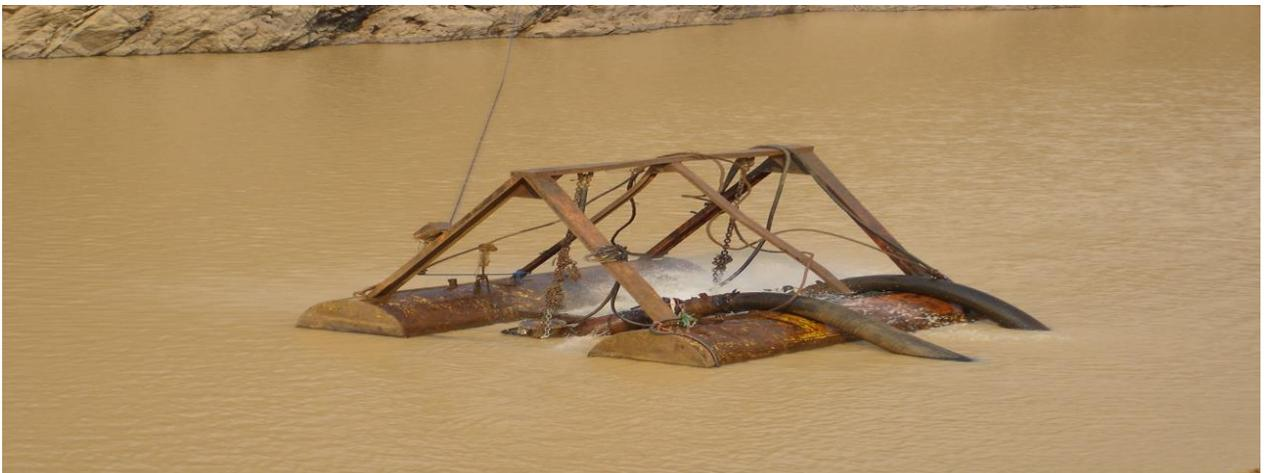
**Fig. 5.4- Bombas Flygts – Drenagem do bloco. Fonte: Sociedade Mineira do Cuango**
