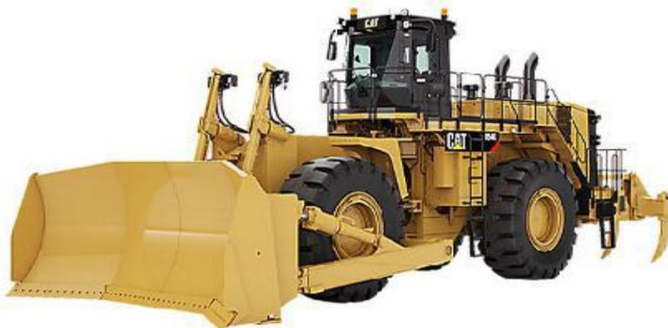
**Fig. 6.2- Trator de Pneus “bulldozer. Fonte: caterpillar**
