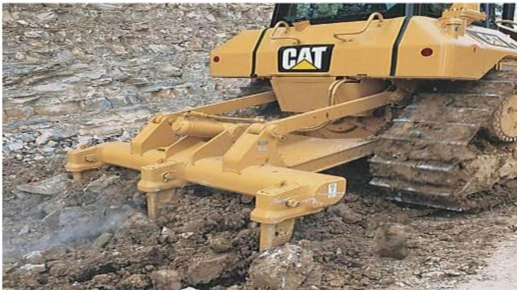
**Fig. 6.3- Utilização do Escarificador “bulldozer” Fonte: caterpilla**
